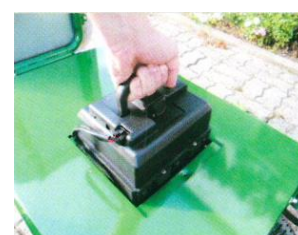
Changement de la batterie
